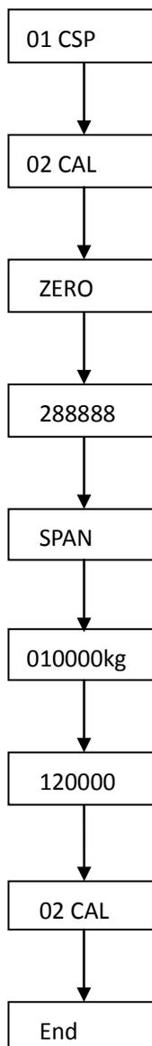
注意：标定零点时传感器的输入信号不能大于 5mv。
