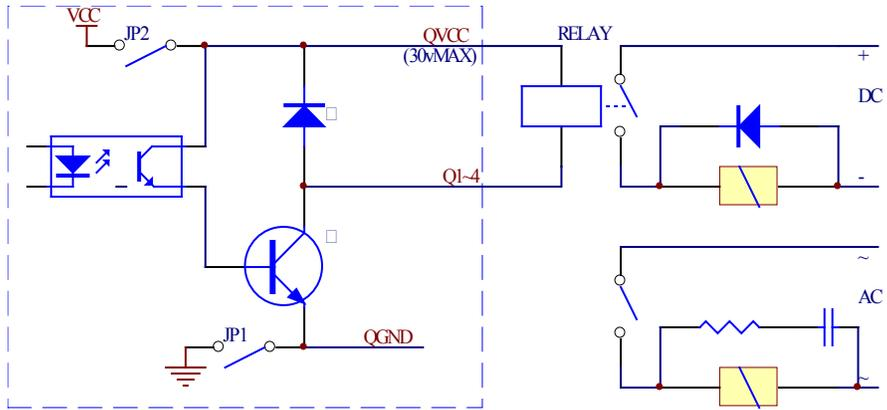
晶体管输出接线示意图
